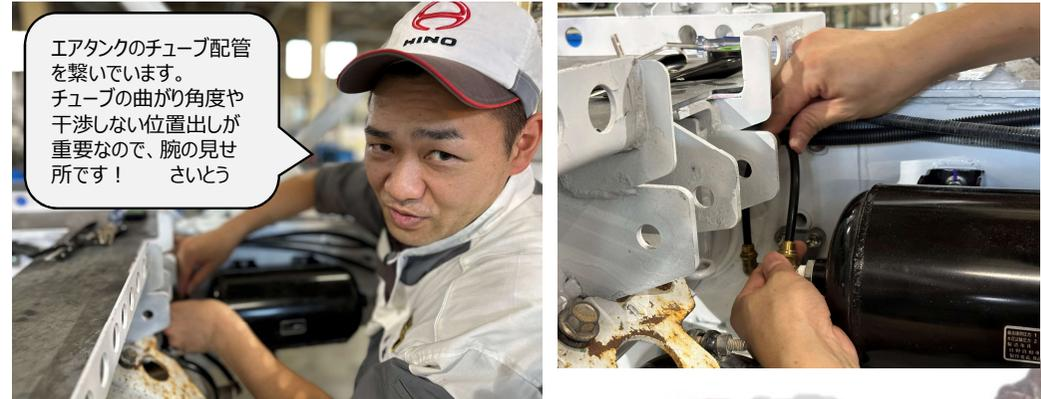
エアタンクのチューブ配管を繋いでいます。チューブの曲がり角度や干渉しない位置出しが重要なので、腕の見せ所です！ さいとう
