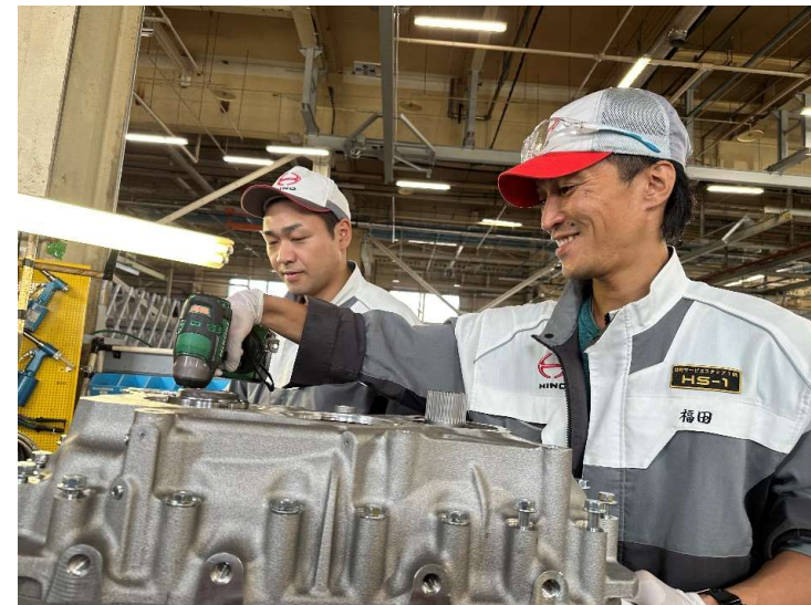
↑レース車600シリーズのトランスファーの組み立て。 納得いくまで調整を繰り返し、最高の一品を仕立てます。
