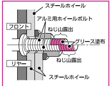
※この図は正しい組み合わせを断面図で示したものです。
